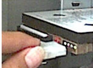
Pemasangan kabel power HDD (Harddisk)
