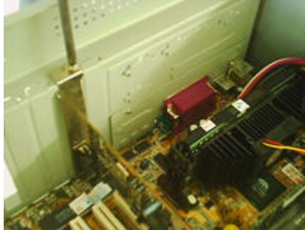
Gambar Pemasangan baut VGA Card
