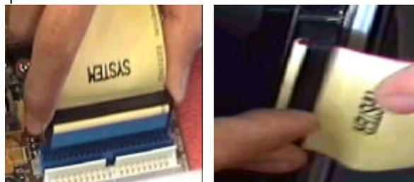
Pemasangan kabel data Harddisk. Perhatikan arah pemasangan kabel (pin 1 kabel yang berwarna merah),pin 1 biasanya terpasang dekat kabel power.
