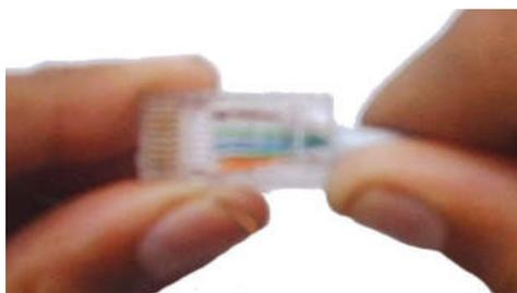
*Gambar Memasukkan Kabel UTP ke dalam RJ-45*
